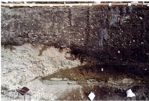
滋賀県高島市で実施された琵琶湖西岸断層帯・饗場野(あいば)の断層のトレンチにあらわれた地層のズレ。写真左下から右上のずり上がる逆断層が観察できる。(写真提供:高島市教育委員会)
