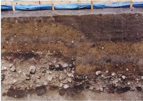
茨木市内で実施された有馬-高槻構造線活断層系、真上断層のトレンチにあらわれた、地層のズレ。一番新しい地震では、室町時代の地層までがずれており、江戸時代の地層がずれていないので、1596年の慶長伏見地震でずれたことがわかった。(写真提供:産業技術総合研究所・吉岡敏和氏)
